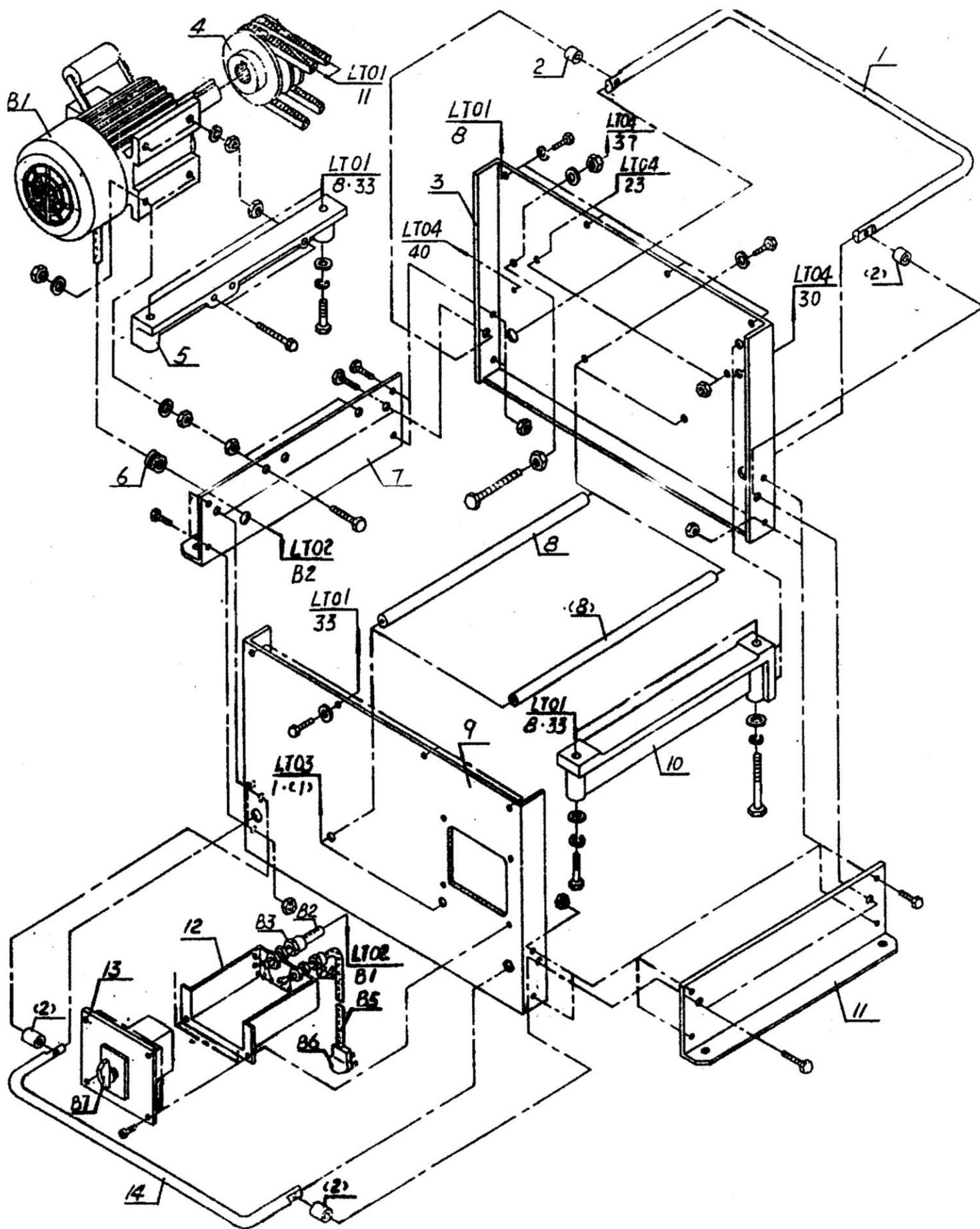
**Детали сборки «КОРВЕТ 320» (Рис. ЛТО 3А)**
