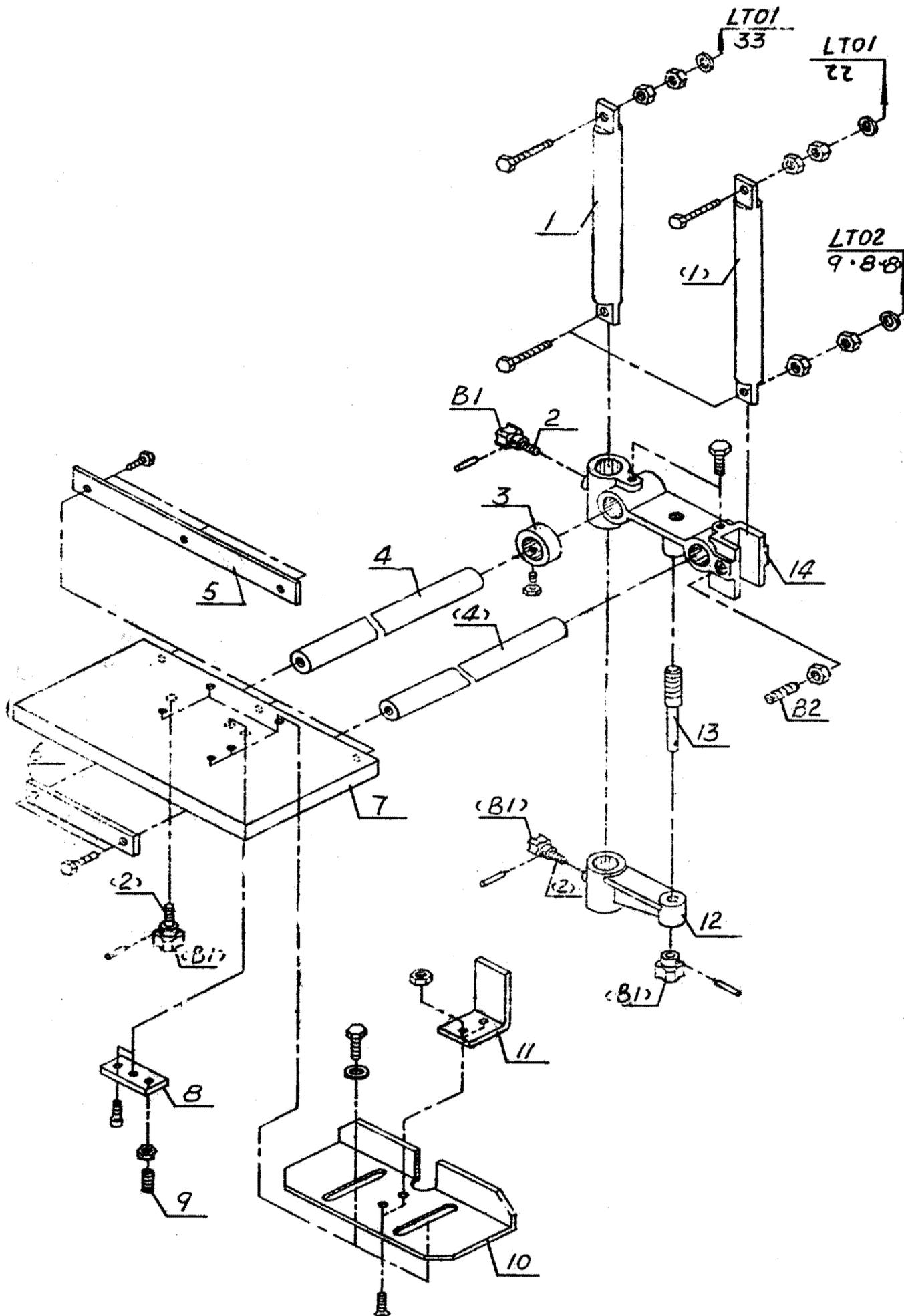
Схема сборки станка «КОРВЕТ 320» (Рис. LTO 4 и LTO 5)
