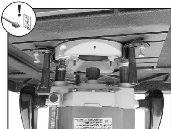
Рис. 13. Фрезер прикреплен к фрезерному столу.
